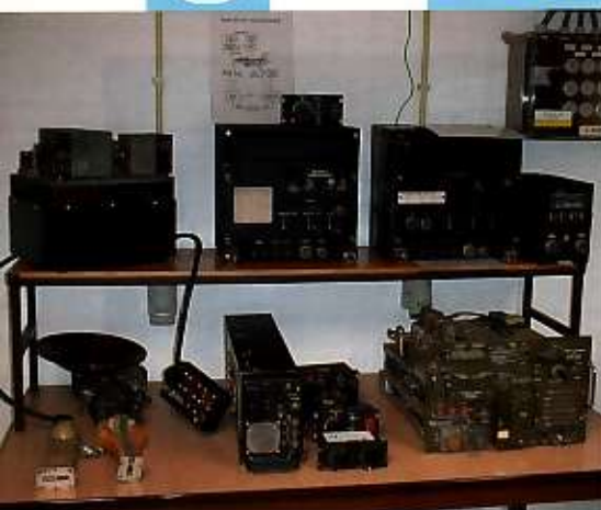
Enkele voorbeelden van IFF apparatuur zoals de APX-6, APX-25 en de UPX-6.
